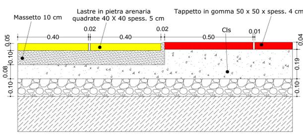
PARTICOLARE COSTRUTTIVO SEZIONE B.B SCALA 1:10
